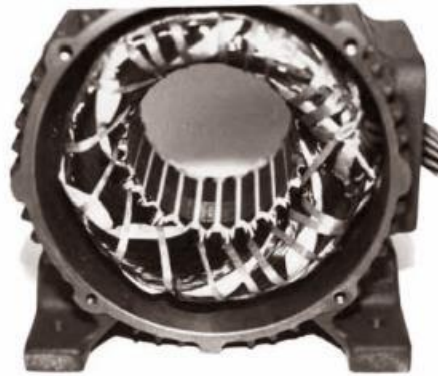
Gambar 2. 2 Stator dari motor induksi, menunjukkan kumparan stator
