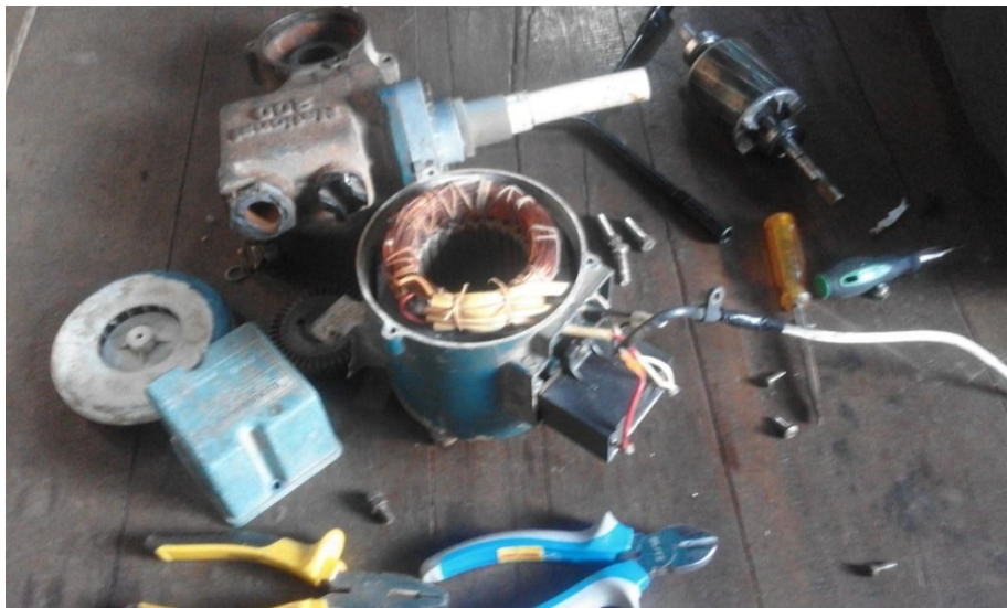
Gambar 6. Konstruksi motor 1 fase
