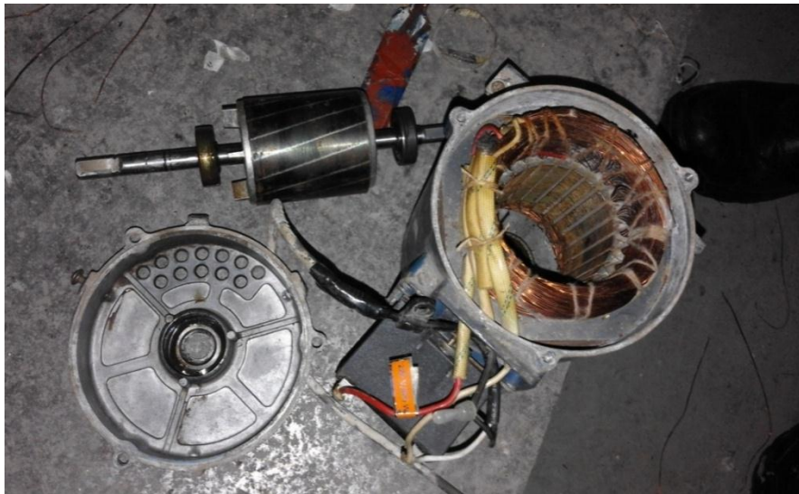
Gambar 4. Konstruksi motor setelah dibongkar
