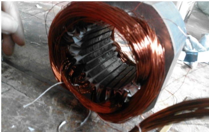
Gambar 2. Bentuk kumparan 2 kutub stator
