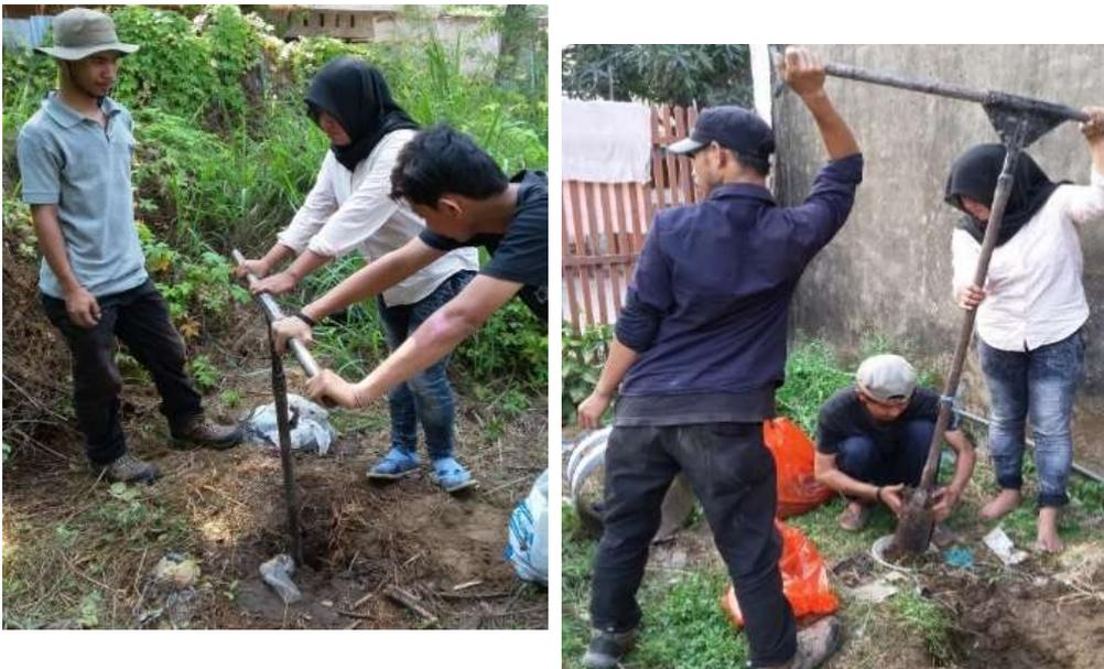
Gambar 8. Pengambilan dan pengemasan sampel tanah
