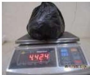
(e). Penimbangan tanah dari lubang *sand cone*
