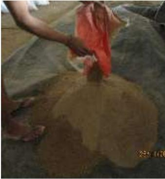
(d). Penggambungan tiga *gradasi* sampel tanah
