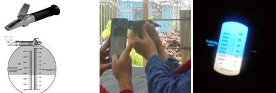
Gambar 26. Pembacaan data sampel air laut, alat ukur Salinometer,
