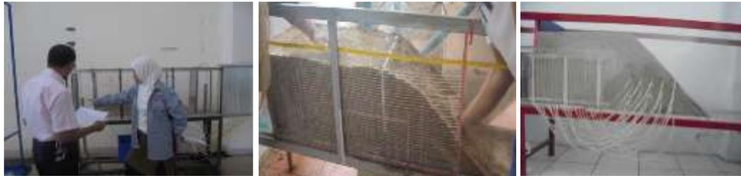
Gambar 22. Pembuatan sampel akuifer pantai pasir
