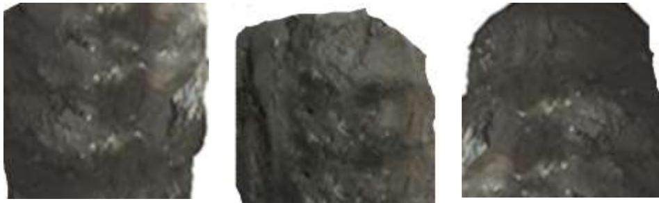
Gambar 27.(a) Hasil uji Sampel dengan kadar soil : semen 7 :1,
