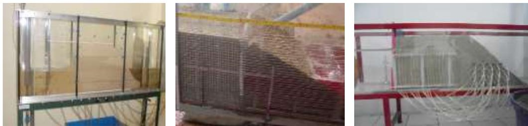
Gambar 23. Hasil sampel akuifer pada model flume
