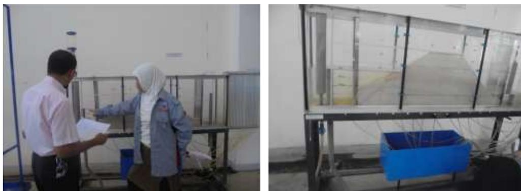
Gambar 25. Pengukuran permeabilitas pasir menggunakan alat Eunha Permeability
