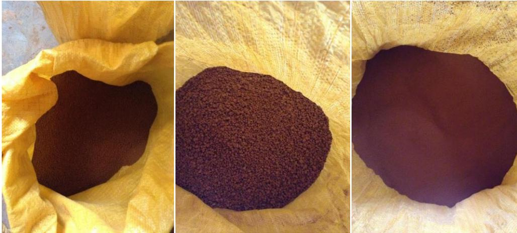
**Gambar10. Hasil Pembuatan tanah sampel yang terdiri dari debu, pasir dan liat**
