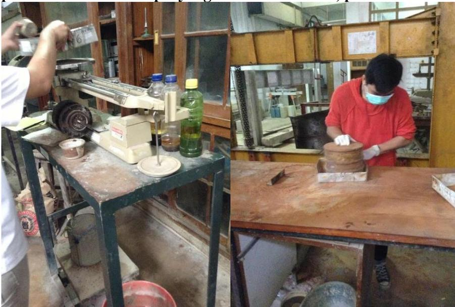
**Gambar9.Pembuatan Tanah Sampel**
