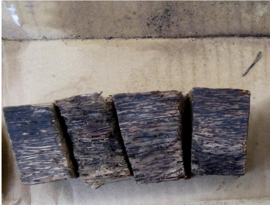
Gambar 9. Sampel Uji Kayu Lontar (*Borassus Flabellifer*) Yang Diberi Perlakuan Yaitu Air Panas
