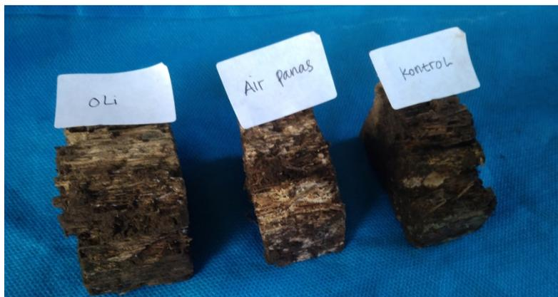
Gambar 4. Sampel kayu Lontar yang sudah diserang Rayap Tanah
