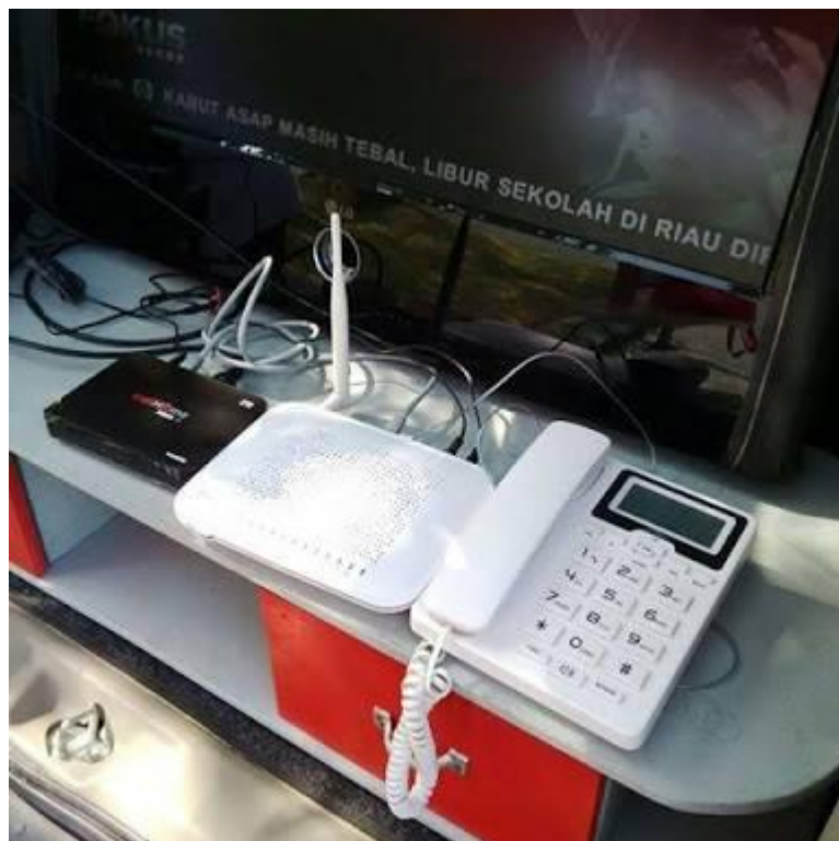
Gambar 4.1 Modem Internet dan Set Top Box UseeTV IndiHome
