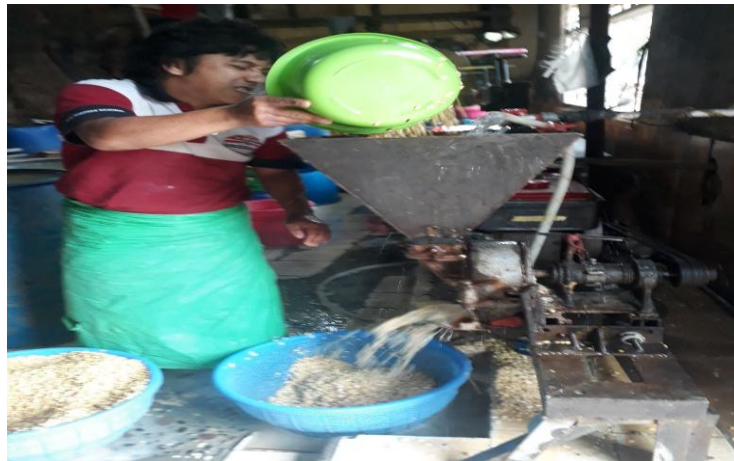
✓ Proses Penggilingan Kedelai
