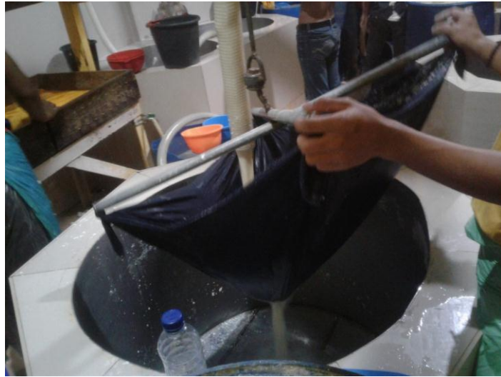
✓ Proses Penyaringan Ampas Kedelai
