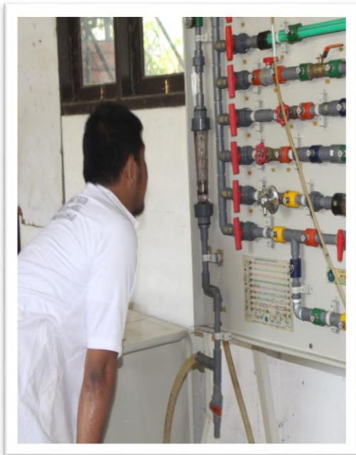
Pengaturan Debit Pada Flowmeter
