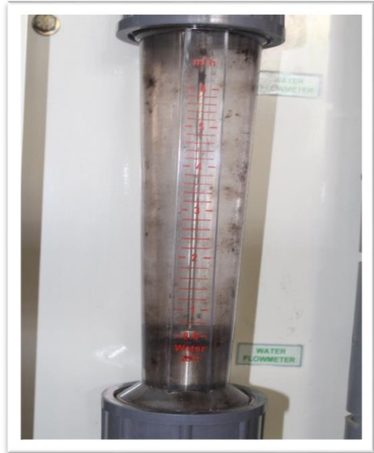
Pengaturan Debit Pada Flowmeter
