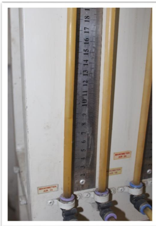
Pembacaan Tekanan Air Pada Manometer
