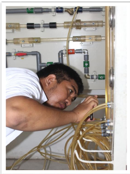
Pembacaan Tekanan Air Pada Manometer
