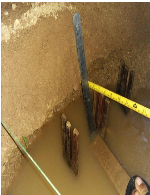
Pengukuran langsung volume gerusan pada tebing saluran
