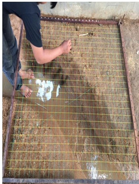
Pengambilan data topografi menggunakan grid
