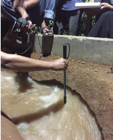
Pengukuran kecepatan aliran menggunakan flow watch
