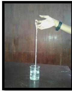
2. masukkan termometer pada wadah yang berisi air panas (seperti pada gambar di atas) amati dan catat hasil pengukuran yang ditunjukkan oleh termometer?. Catat pada Tabel 1!
