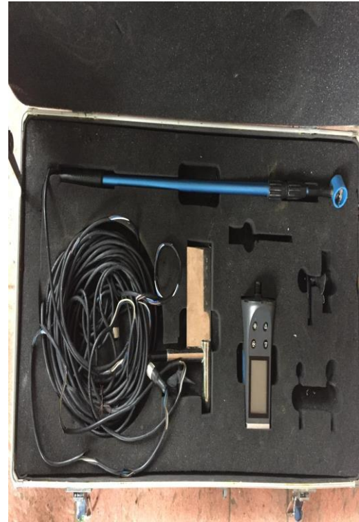
Alat Ukur Kecepatan Flow Watch
