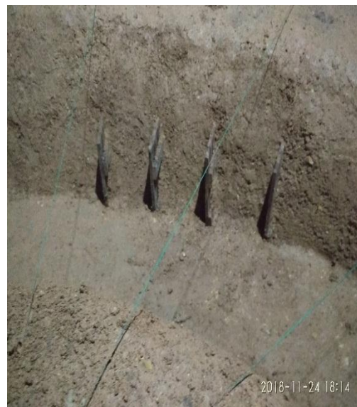
model pemasangan krib impermeable
