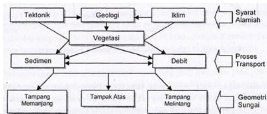
Gambar 1. Sistem proses pembentukan dasar sungai/morfologi sungai ( Mangelsdorf & Scheuermann, 1980 dalam Agus Maryono. 2009)
