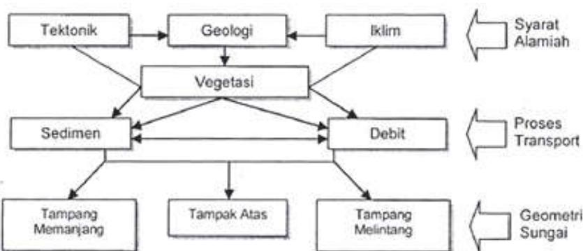
Gambar 1. Sistem proses pembentukan dasar sungai/morfologi sungai
