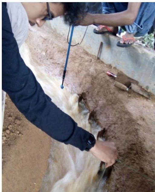
Proses Pengukuran Kecepatan dengan *Flow Watch*
