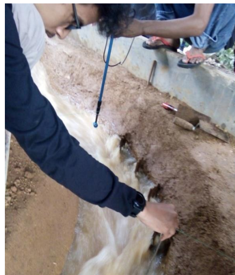
Proses Pengukuran Kedalaman aliran
