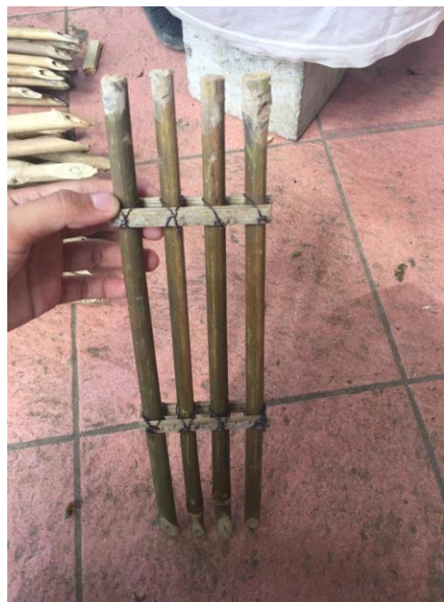
Bentuk krib bambu tipe permeabel
