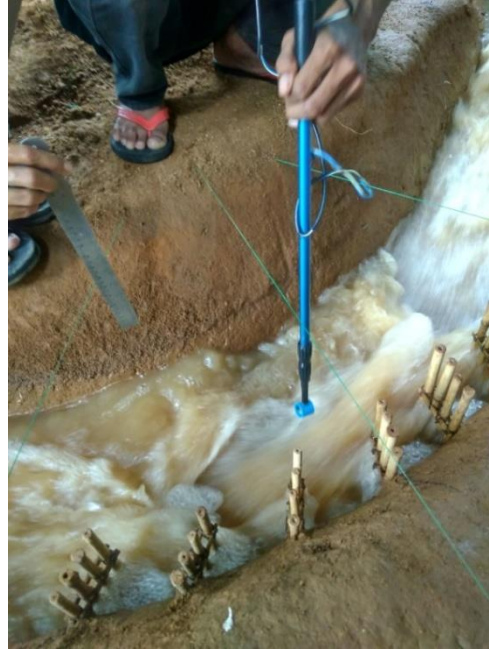
Pengambilan data kecepatan aliran dengan sudut krib permeabel
