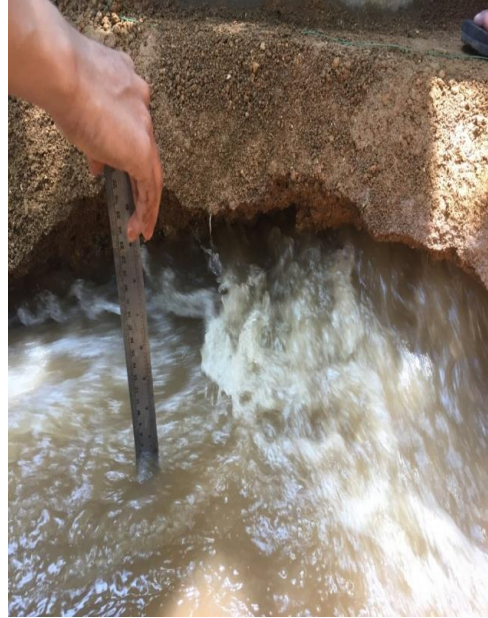
Pengukuran kedalaman aliran menggunakan mistar
