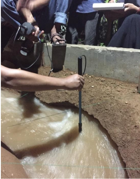
Pengukuran kecepatan aliran menggunakan Flow Watch
