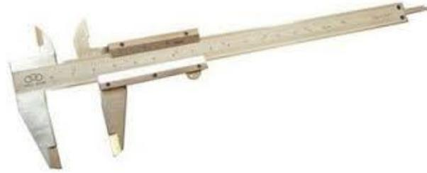
Gambar 2.1. Alat ukur jangka sorong
