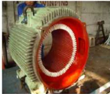
Gambar 2.6 Bentuk konstruksi stator pada generator sinkron(faizalnizbah :2013)
