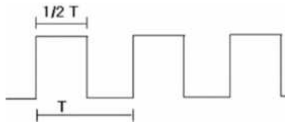
Gambar 2.13 Pulsa dengan duty cycle 50% (Hendrik, 2013)
