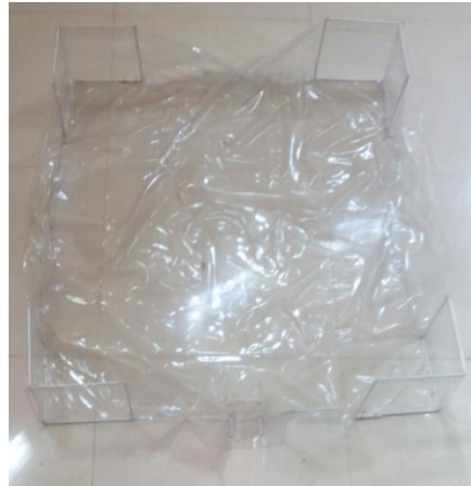
Sumber : Laboratorium hidrologi Fakultas Teknik Unismuh Makassar Gambar 3.3 Media uji tangkapan air hujan
