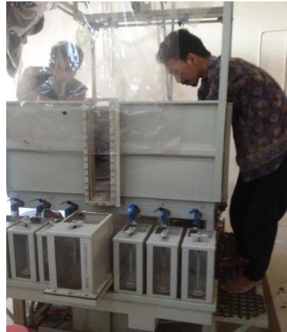
Pengisian Sampel Pada Bak Uji
