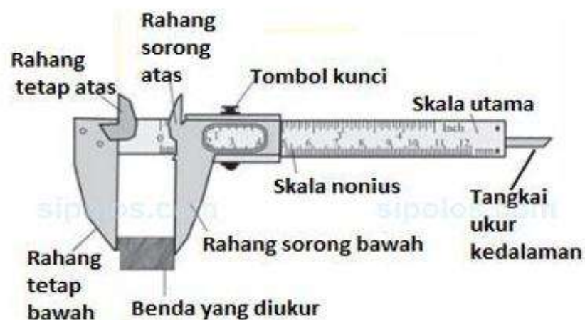
Bagian bagian Jangka Sorong
