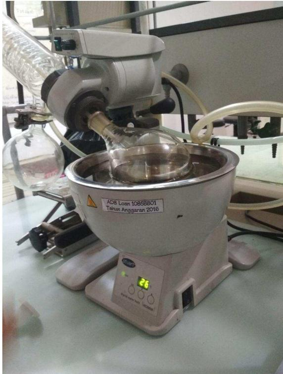
Proses pemisahan pelarut dan zat terlarut menggunakan *rotary evaporator*
