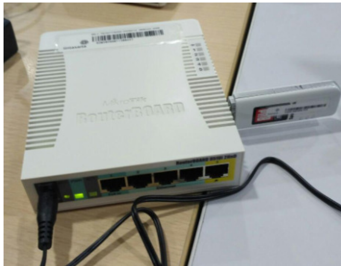
Gambar 4.2 Modem HSDPA terpasang pada Mikrotik
