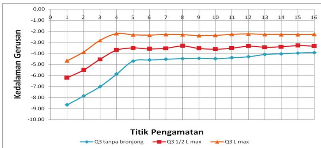
Gambar 29: Kedalaman gerusan rata-rata pada (Q 3 ) dan waktu yang bervariasi tanpa bronjong, dengan bronjong \frac{1}{2} L max dan bronjong sama dengan panjang kolam olakan.
