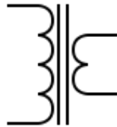
Gambar 2.5. Skema transformator step down
