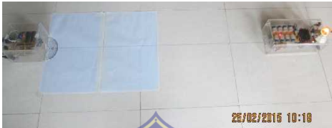
Gambar 1 pengujian alat jangkauan 100 cm dengan sudut 0^\circ (sejajar)
