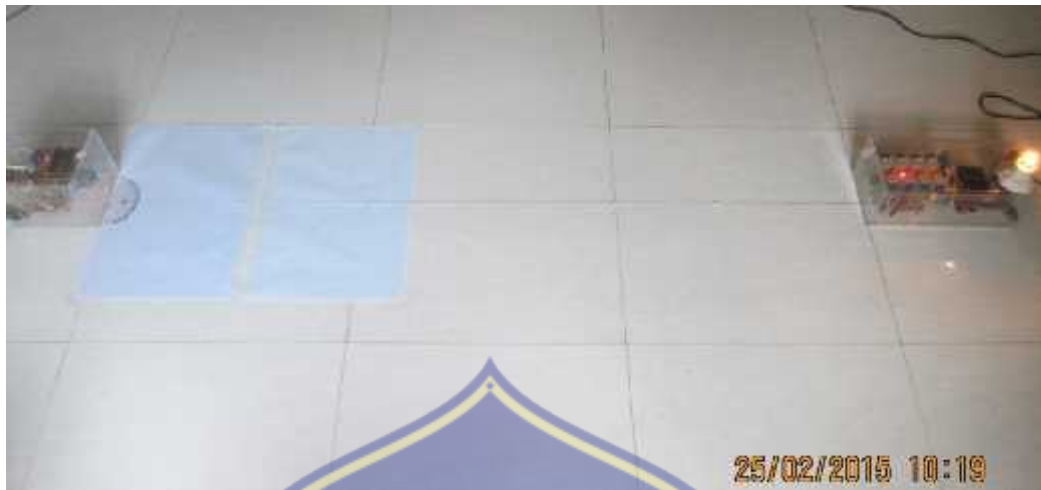
Gambar 11 pengujian alat jangkauan 150 cm dengan sudut 0^\circ (sejajar)
