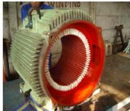
Gambar 2.6 Bentuk konstruksi stator pada generator sinkron
