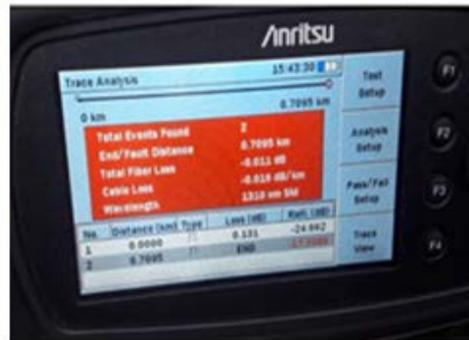
PENGUKURAN JARAK DI OTDR
