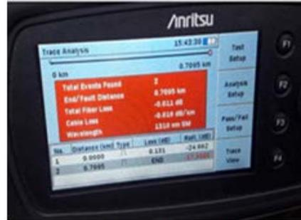
PENGUKURAN JARAK DI OTDR
