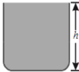
Gambar 1.2.zat cair bermassa m terdapat pada bejana setinggi h dengan luas penampang A .
