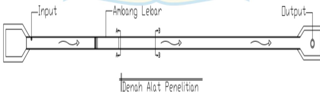
Gambar 10 . Gambar Denah saluran terbuka ( flume test )
