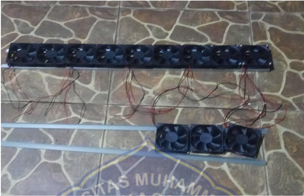
GAMBAR 3. PROSES PEMASANGAN KIPAS KE SIKU L
