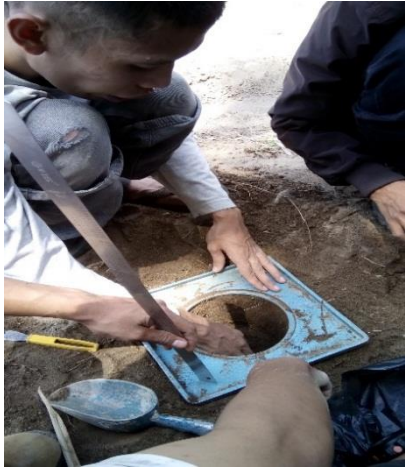
Pengujian Sand Cone Lapangan
