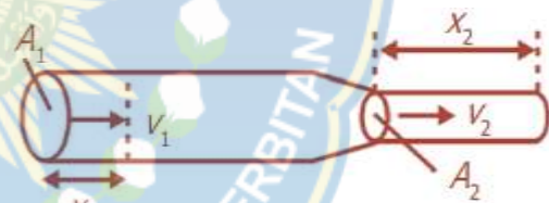
Gambar 9. Aliran fluida pada pipa yang berbeda penampangnya
