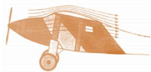
Gambar 2. Garis-garis arus di sekitar sayap pesawat terbang
