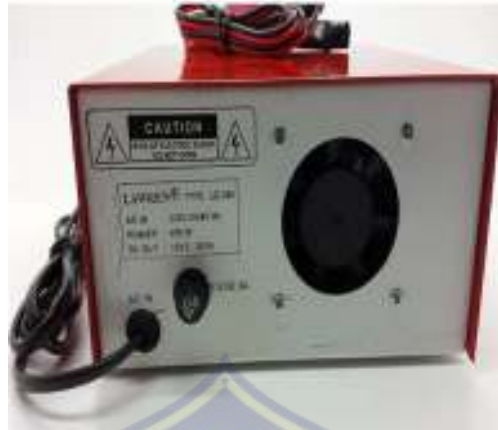
Gambar 2.9 Charger baterai 220 Volt 180 watt
