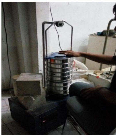
Pengujian Analisa Saringan
