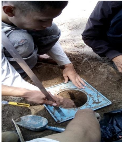
Pengujian Sand Cone Lapangan
