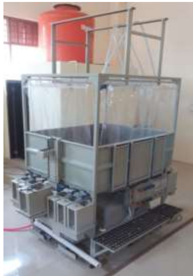
Gambar 5. Alat Simulasi Hujan ( Rainfall Simultor )
