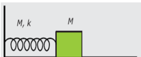
Gambar 2 Gerak balok yang tertahan oleh pegas
