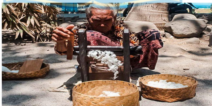
Gambar 4.1 Seorang ibu sedang memisahkan biji dan kapas pohon dengan alat penggencet atau keho . (Dokumentasi Sonny Syaputra, Januari 2019)
