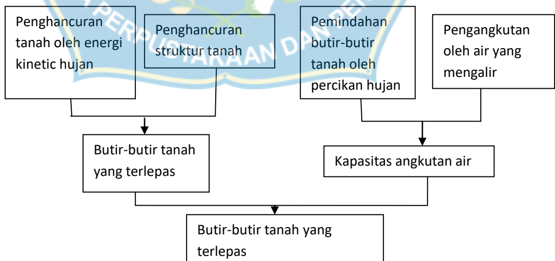
Gambar 1 bagan alir model proses oleh air. (sumber ; Suripin, 2004 )
