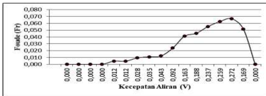
Gambar 27 . Grafik Hubungan Antara Bilangan Froude (Fr) Dengan Kecepatan Aliran (V) Pada Saat Muka Air Minimum
